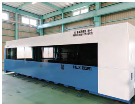
大型ファイバーレーザー加工機(加工範囲:2×6m)
